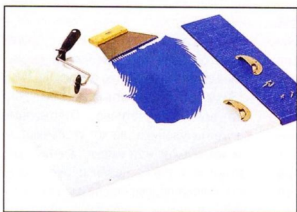
Синтетическая грунтовка, акриловый лак голубого цвета, малярный валик и зубчатый шпатель — эти материалы и инструменты сослужили добрую службу при отделке фасадов кухонной мебели.
